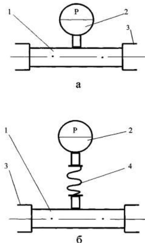
1 – корпус; 2 – манометр; 3 – головка муфтовая; 4 – гибкий шланг
